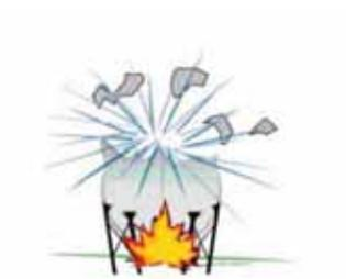
Rupture de la structure de stockage et libération du gaz et du liquide sous pression
