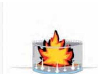
Baisse du niveau d'hydrocarbures dans le réservoir
